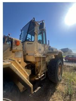
Objet n° 5 : 1 chargeur CATERPILLAR 966 D, N° 94X03256, affichant 10612 Heures Année 1984, Batterie H.S
